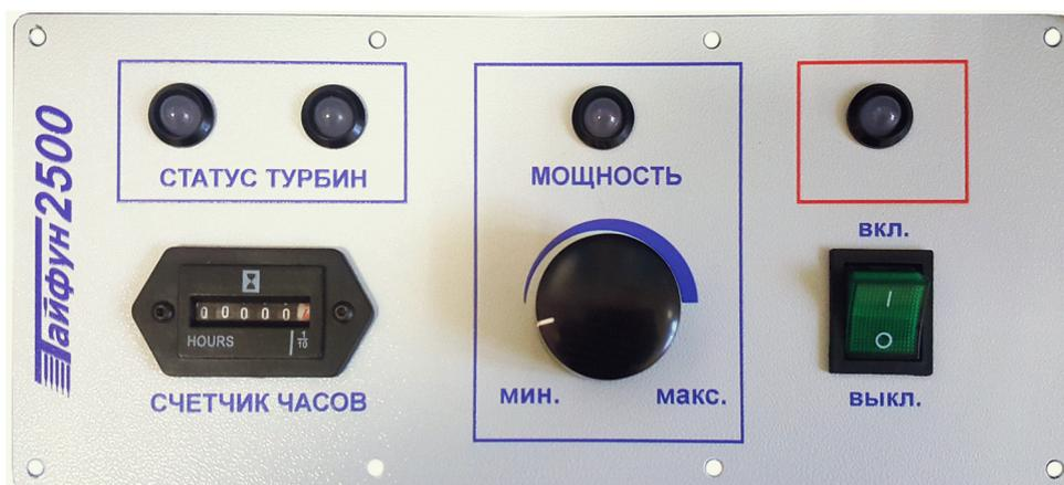
На панели управления вытяжной системы «Тайфун» расположен выключатель питания, ручка регулировки оборотов двигателя, счетчик часов наработки и индикаторы статуса (состояния) турбин.
