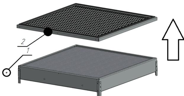
б) высыпать использованный уголь 1 в плотный мешок.
